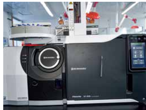
日本岛津三重四级杆气质联用仪( GC-MSMS )，主要用于农残、兽残检测
