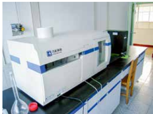
北京普析通用仪器有限责任公司非色散原子荧光光度计，主要用于重金属检测
