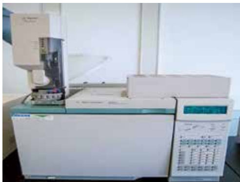
美国安捷伦仪器有限公司 6890N 气相色谱仪（配 ECD/FPD 检测器），主要用于农残检测
